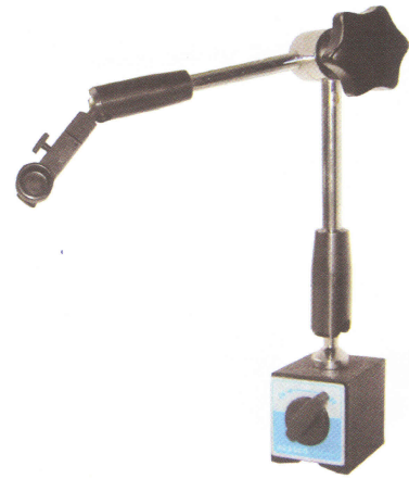
BASE MAGNÉTICA SISTEMA HIDRÁULICO E AJUSTE FINO
